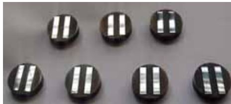
Wear Specimens Fabricated Through DMD Process डीएमडी प्रक्रिया के द्वारा घिसे हुए नमूनों का निर्माण
