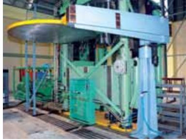
Spill Tray for VM 4.5T Mixer वीएम 4.5टन मिक्सर के लिए स्पिल ट्रे
