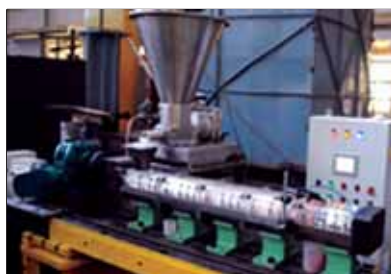
Twin Screw Continuous Mixer ट्विन स्कू कंटीन्यूअस मिक्सर
