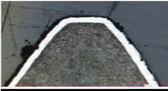
वर्टिकल, कोटिंग की मोटाई 110 माइक्रोन, Coating thickness of 110 micron
