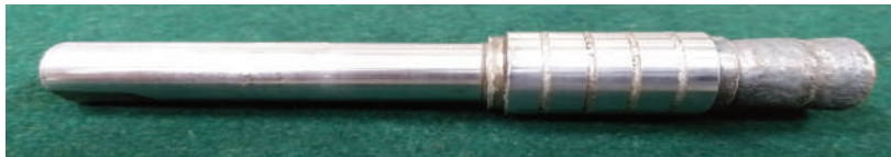
स्पूल का डीएमडी के माध्यम से पुनः निर्माण Spool remanufacturing through DMD process
