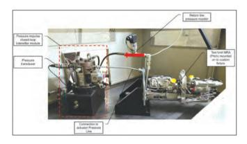
मुख्य रोटर और टेल रोटर एक्चुएटर्स के योग्यता परीक्षण में अनुमोदित प्रकार परीक्षण अनुसूची (टीटीएस) के अनुसार स्वदेशी एमआर और टीआर एक्चुएटर्स का परीक्षण शामिल है। प्राथमिक रोटर एक्चुएटर का एसएई एआरपी 1383 ए के अनुसार दाब आवेग परीक्षण के 10,00,000 चक्रों तक परीक्षण किया गया।
