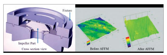
सतह खुरदरापन Ra में 14.5 µm से 3.2 µm तक सुधार
